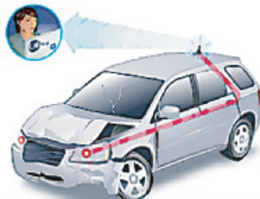
Inbyggda sensorer i fordonet meddelar centralen att något hänt, varpå åtgärder kan vidtas.
